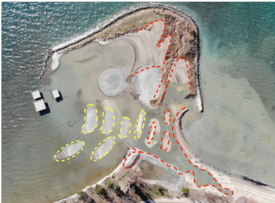
Projet de lagune avec création de bancs de sable: le sable (rouge) est déplacé pour former les îlots à fleur d'eau (jaune), photomontage F. Lehmans.
