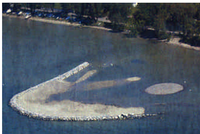
Fig. 16. Sur cette vue aérienne de l'île non terminée (40 m d'enrochement manquent encore à droite), on voit apparaître l'île à sternes et la structure en forme d'arc avec des pentes douces inondables. Préverenges, juin 2002. P. Maeder
